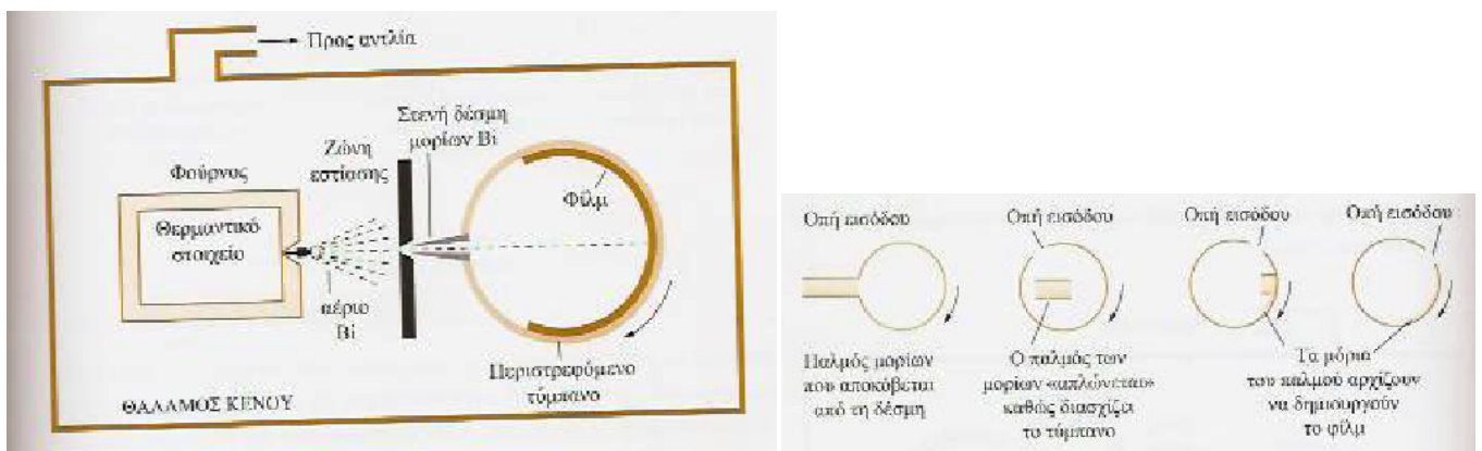
Σχήμα 7.1: (αριστερά) Η συσκευή περιστρεφόμενου τυμπάνου (rotating-drum apparatus) που χρησιμοποιείται για τον πειραματικό προσδιορισμό των μοριακών ταχυτήτων ενός αερίου. (δεξιά) κίνηση ενός αριθμού μορίων μέσα στο περιστρεφόμενο τύμπανο και πρόσκρουση στην απέναντι επιφάνεια όπου είναι προσαρμοσμένο ένα φιλμ.
