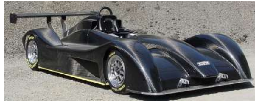
Ανθρακονήματα στην αυτοκινητοβιομηχανία (Stohr DSR)
