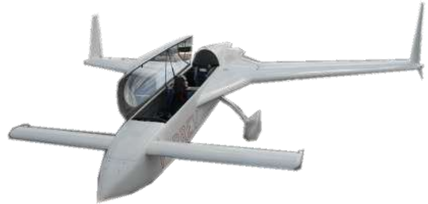
αεροπλάνο κατασκευασμένο από fiber glass
